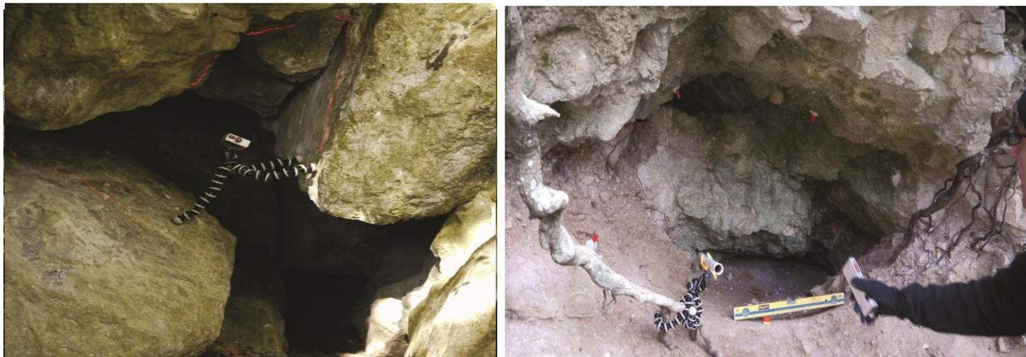
**Fig. 6.5** – Operazioni di misura della velocità del flusso d'aria presso Grotta della Rocchetta e Grotta degli Arnolfi.
